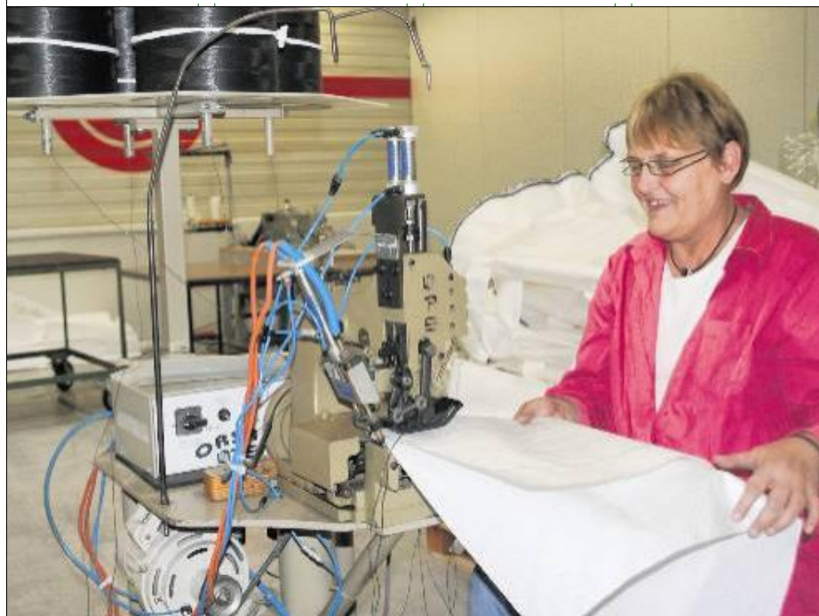
Elisabeth Sievers demonstriert, wie die Bigbags in Handarbeit zusammengenäht werden.
