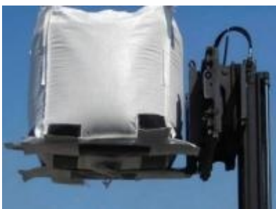
Palette überflüssig: Der neu entwickelte Bigbag hat überdies eine Auslassöffnung für das Füllgut im Boden. Foto prf
